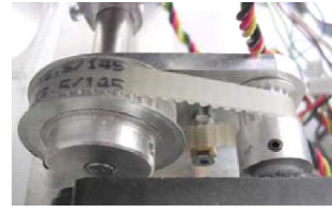
Figura 2-5 - Conjunto servomotor, correia de transmissão e polia
